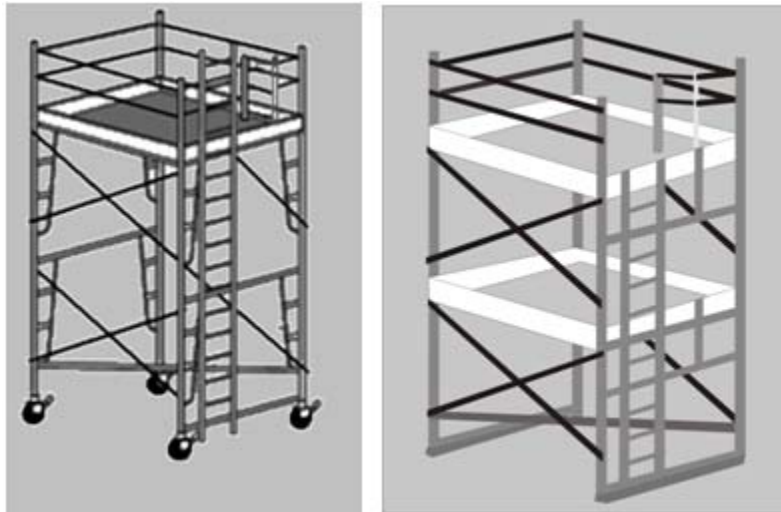
Figura 5 Andamios tipo torre o estructura
